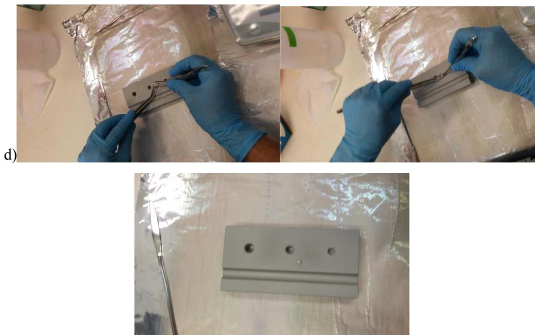
Figura 8. Técnica para encapsular la muestra de músculo para su posterior análisis en el espectrómetro de masas atómicas. a) El músculo se deja en la incubadora a 60° por 24 horas, b) una vez seco, el pedazo de músculo se pulveriza en un mortero de ágata, c) se coloca 1 mg del polvo dentro de una cápsula de estaño, d) la cápsula se comprime con pinzas hasta no dejar nada de aire dentro.
