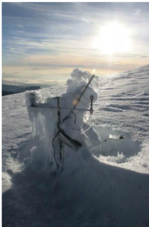
Figura 5.1: Condiciones de condensación de agua sobre los instrumentos de la estación AWS-Glaciár. Foto tomada por José Manuel Álvarez Nieves (Septiembre 2010)
