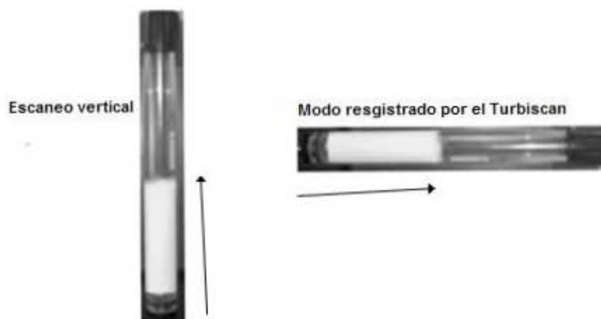
Figura 3.11 Tubo especial, forma de escaneo y registro, para el análisis de la estabilidad de la emulsión en el instrumento Turbiscan.
