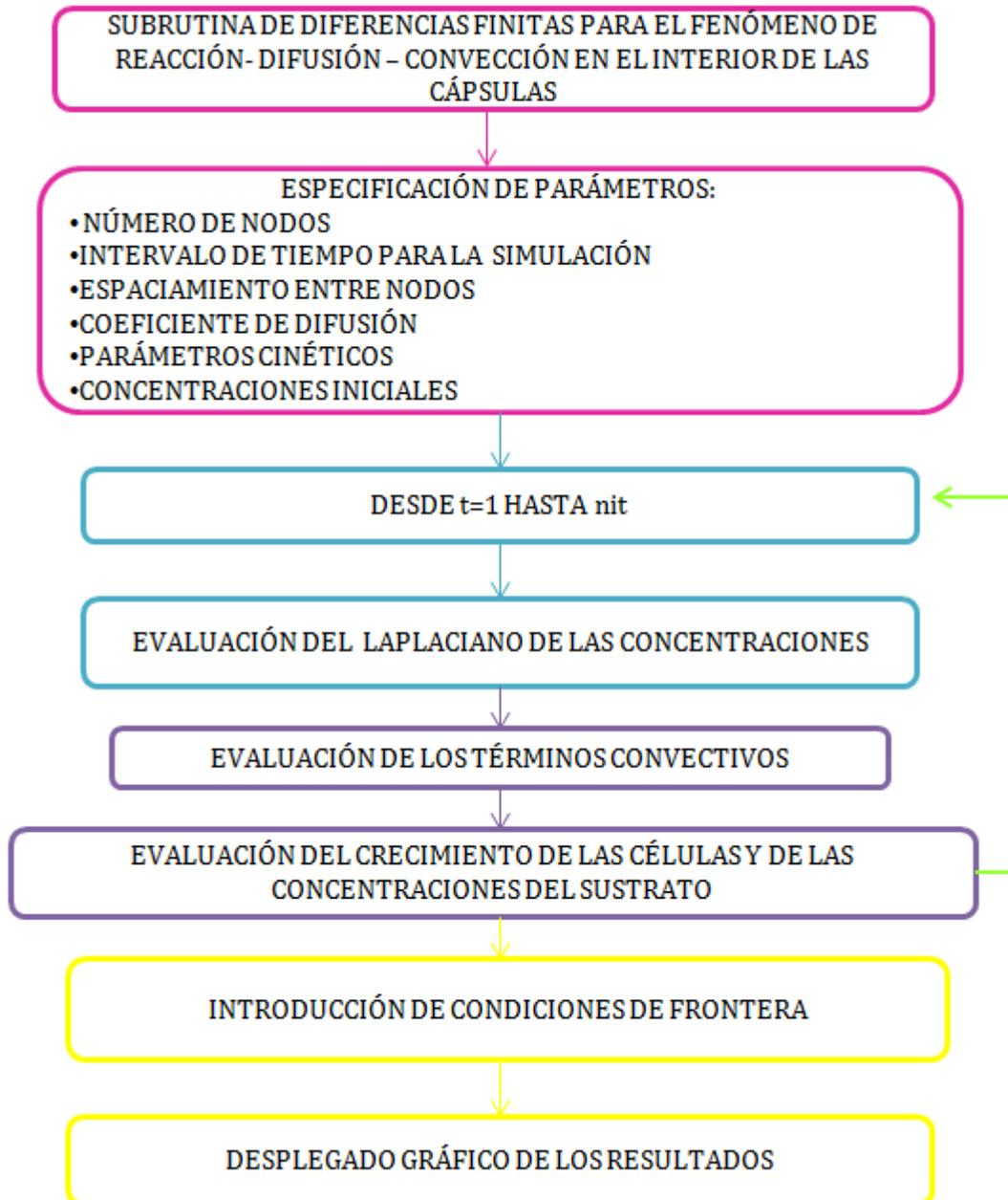
**Diagrama 2.** Descripción del algoritmo computacional para el fenómeno de reacción-difusión-convección dentro del biorreactor
