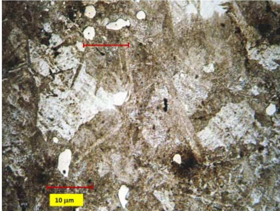
Figura 4.8. Acero AISI A2, tratamiento de austenizado de 4 h, a 1100 °C. Y 4 h + 4 h de revenido doble a 500°C. Carburos de cromo Cr_7C_3 (partículas esféricas de color blanco) dispersos en una microestructura base de perlita, ferrita y austenita revenida. Micrografía a 1000X.
