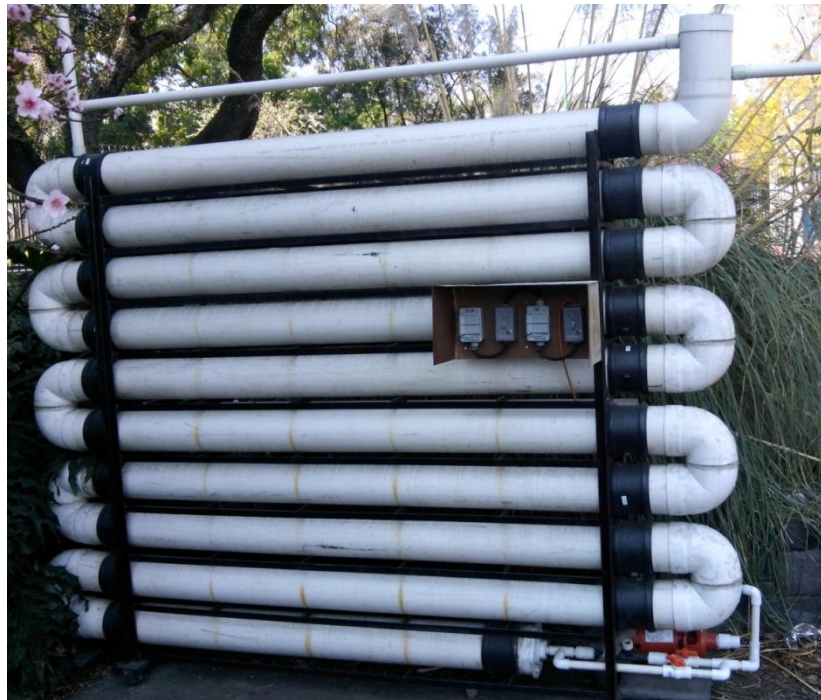
Figura 4.14 Reactor biológico aerobio terminado
