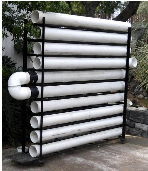
Figura 4.2 Colocación de cada sección en el soporte de acero
