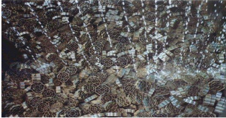
Figura 2.2 Soportes plásticos de forma circular más ampliamente utilizados para el desarrollo de la biopelícula (Rocha, 2008).
