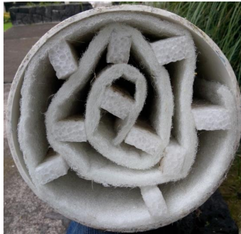
Figura 4.15 Soporte de fibra espiral para biopelícula
