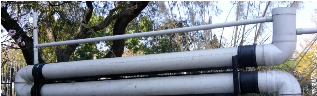
Figura 4.12 Sedimentador para la retención de biomasa a la salida del reactor
