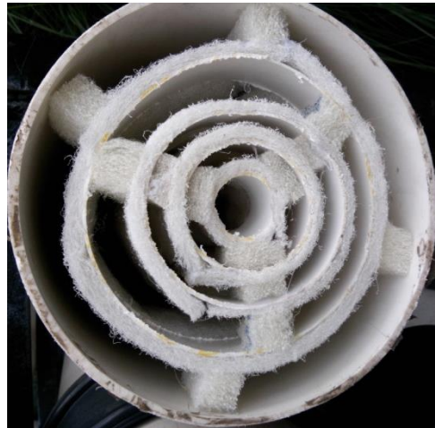
Figura 4.16 Soporte de fibra circular para biopelícula
