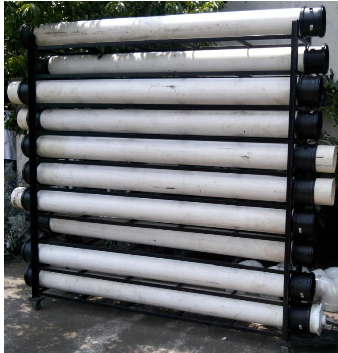
Figura 4.3 Colocación de coples de reparación en cada sección tubular
