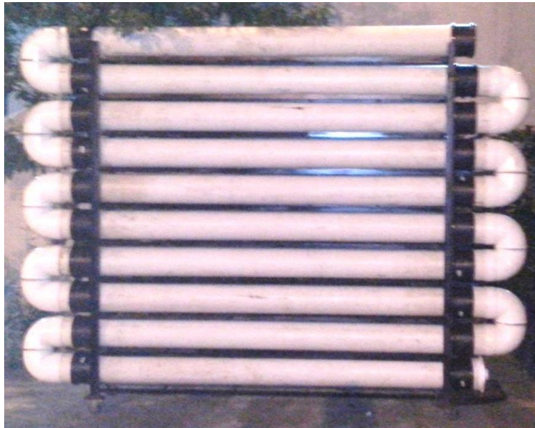
Figura 4.6 Construcción del arreglo tubular del reactor biológico
