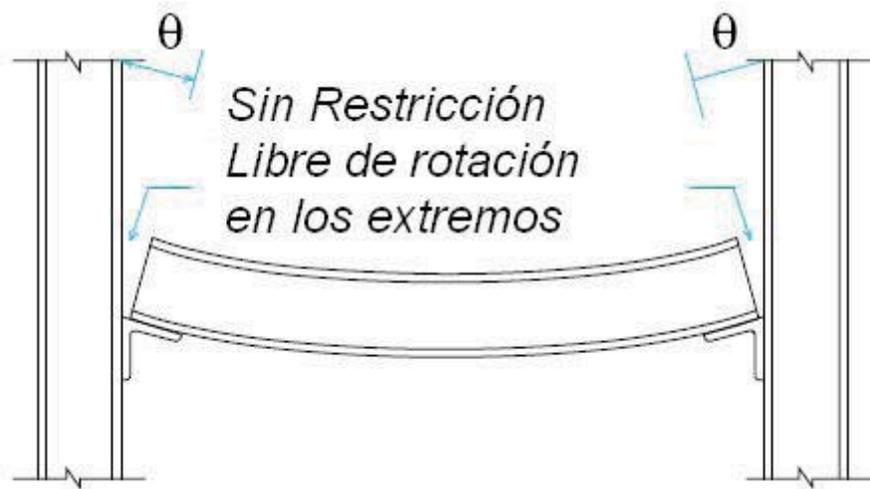
Imagen 2.9. Conexión simple o libremente apoyada.
