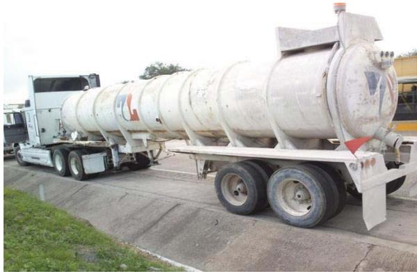
Figura 3.33. Pipa transportadora de material residuo del perfilado y texturizado.
