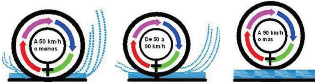
Figura 3.35. Respuesta en lluvia de los neumáticos, según la velocidad del vehículo.
