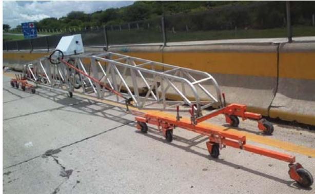
Figura 3.3. Marco y carros de carga del perfilógrafo tipo California.
