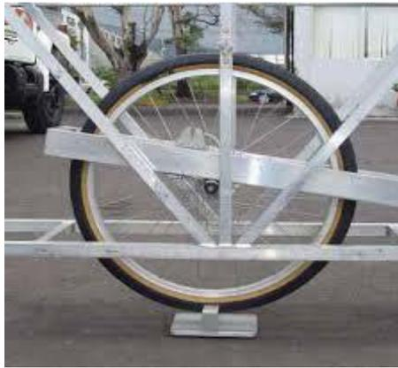
Figura 3.7. Calibración de la escala vertical del perfilógrafo tipo California.
