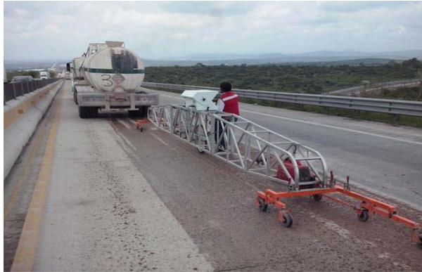
Figura 3.34. Ejecución del perfilado y obtención del índice de perfil posterior.
