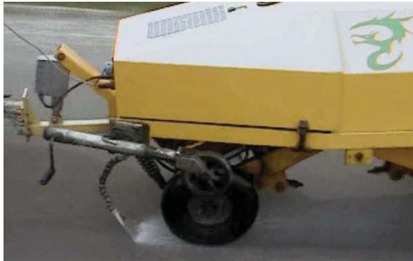
Figura 3.37. Ejecución de la prueba de coeficiente de fricción, posterior a los trabajos de perfilado y texturizado
