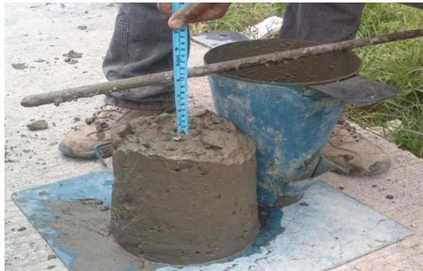
Figura 3.19. Prueba de revenimiento del concreto.
