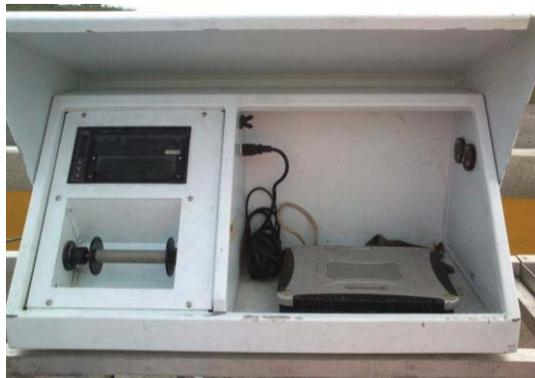
Figura 3.5. Consola de registro del perfilógrafo tipo California.
