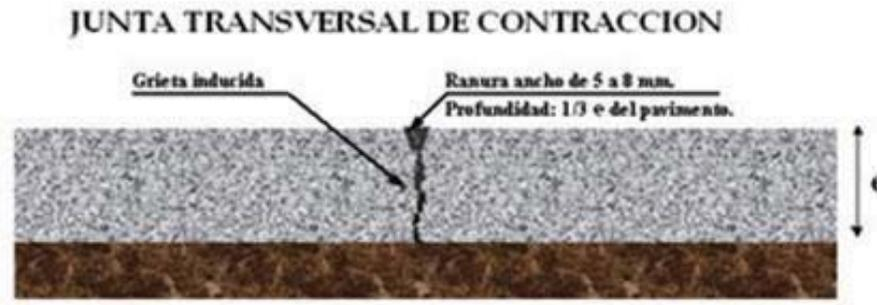
Figura 2.10. Junta transversal de contracción.
