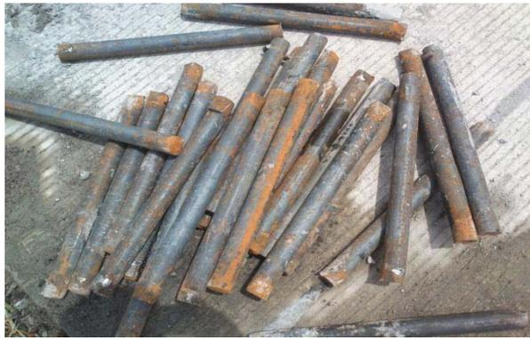
Figura 2.13. Barras pasajuntas (redondas lisas de acero de 1 $\frac{1}{2}$ " de diámetro).
