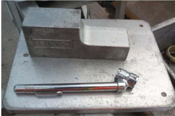
Figura 3.6. Dispositivo para la calibración de la escala vertical del perfilógrafo tipo California.
