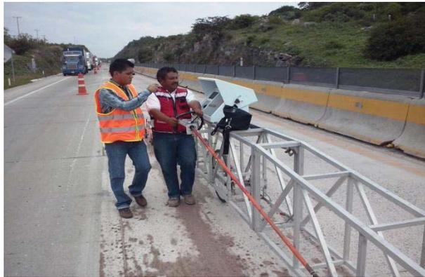
Figura 3.8. Obtención de perfilogramas para la determinación del índice de perfil.
