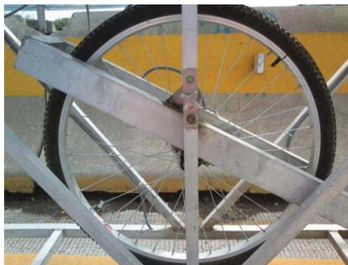
Figura 3.4. Llanta sensora del perfilógrafo tipo California.
