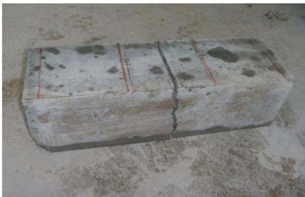
Figura 3.18. Viga de concreto sometida a ensaye de tensión por flexión.
