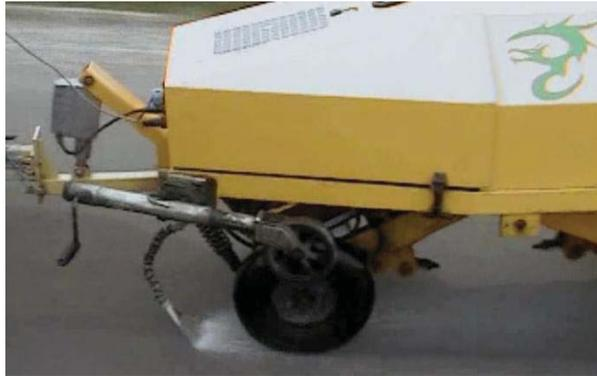
Figura 6.7. Ejecución de la prueba de coeficiente de fricción, posterior a los trabajos de perfilado y texturizado
