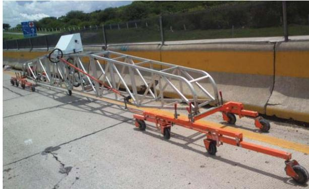
Figura 3.2. Perfilógrafo tipo California.
