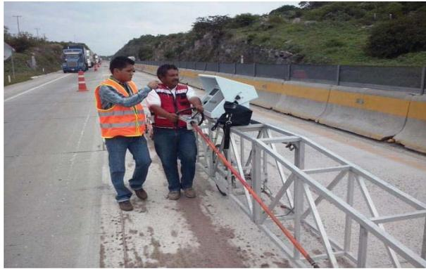
Figura 6.1. Obtención de perfilogramas para la determinación del índice de perfil.
