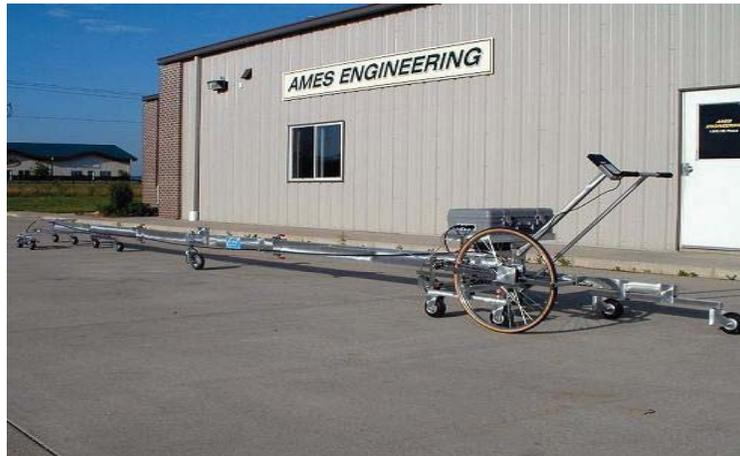
Figura 6.2. Perfilografo tipo California, Modelo 4200, marca AMES.
