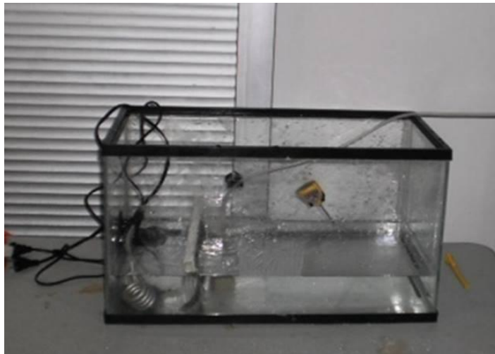
Imagen 2. Dispositivo empleado para conocer la temperatura crítica máxima de juveniles de H. erectus . (Foto: López Ripoll E.).
