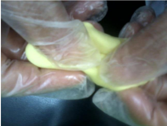
Figura 5. La silicona y el activador son mezclados uniformemente.
