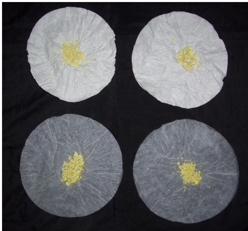
Figura 13. Alimento prueba masticado, los filtros superiores están secos y los inferiores húmedos.
