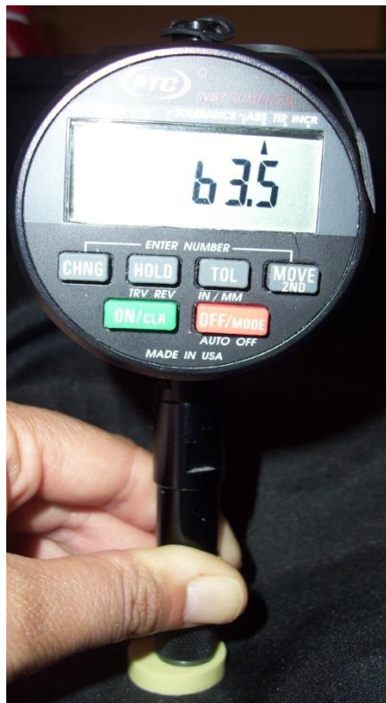
Figura 7. Durómetro digital modelo 211 tipo A, marcando dureza permitida.
