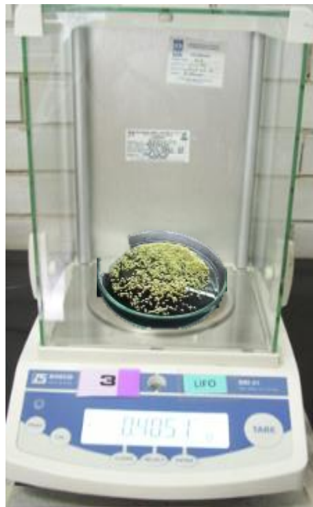
Figura 17. Bascula con precisión de 0.01 g pesando el contenido de un tamiz.
