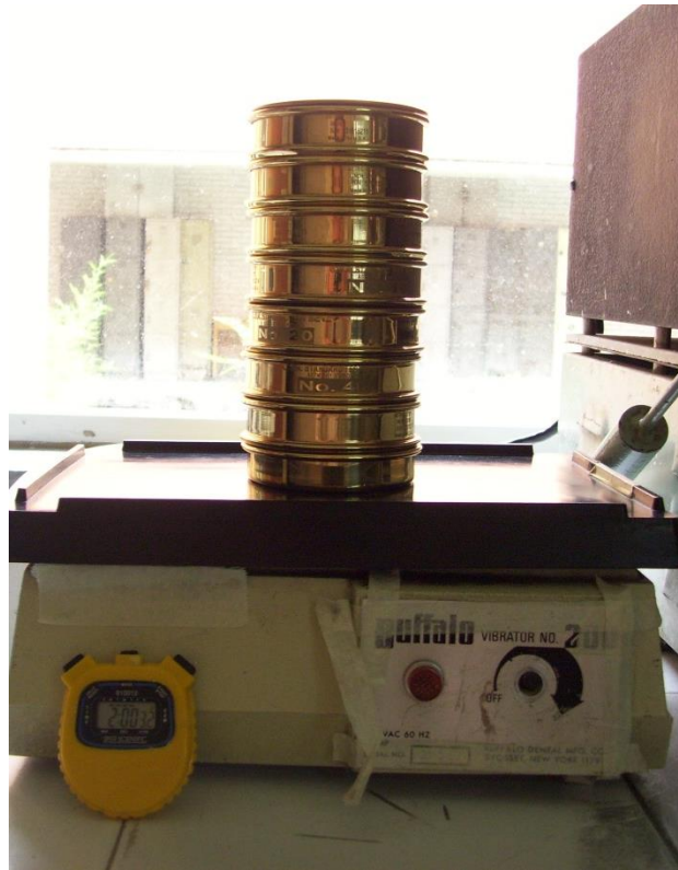
Figura 14. El material previamente secado fue separado a través de una torre de 7 tamices mientras se vibraba durante 2 minutos.
