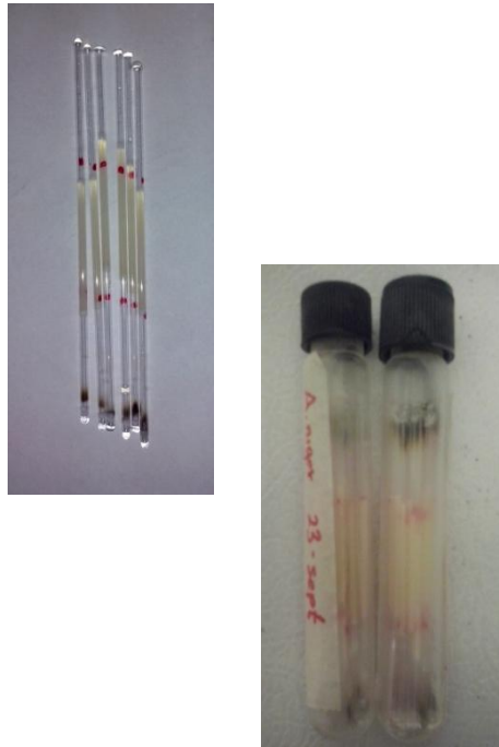
Fotografía 1. A la izquierda, tubos capilares más las esporas con el crioprotector sellado a la flama y a la derecha tubos capilares almacenados en tubo con tapa de rosca etiquetada para su almacenamiento.
