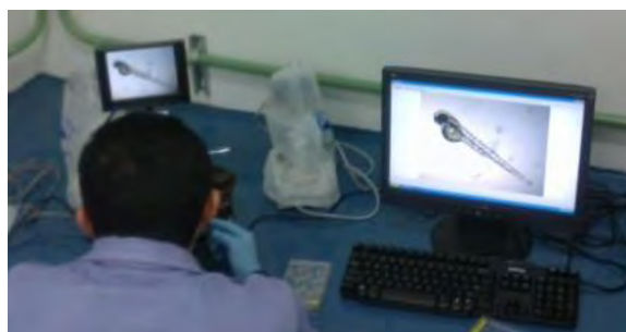
Figura 22. Dispositivo empleado para la observación y medición de los parámetros fisiológicos y morfológicos de embriones de pez cebra.
