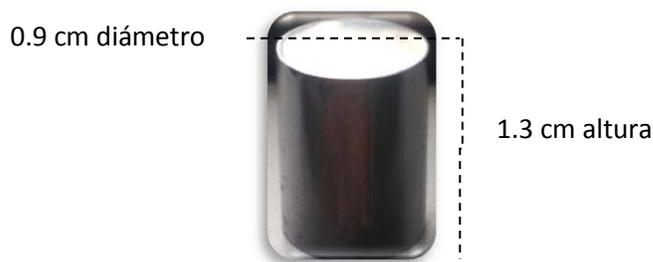
**Figura 2.2** Vista esquemática de las dimensiones de las probetas cilíndricas de acero SAE 1018 utilizadas en las pruebas electroquímicas.
