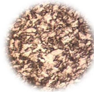
**Figura 3.2** Vista microscópica de un Acero SAE 1018 (probeta de trabajo)
