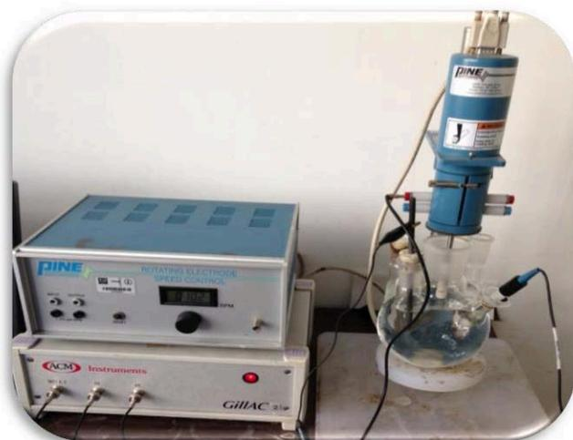
**Figura 2.1** Arreglo experimental de la celda electroquímica de vidrio con el ECR (marca PINE), conectada a cables adquirentes de datos de la terminal GillAc.
