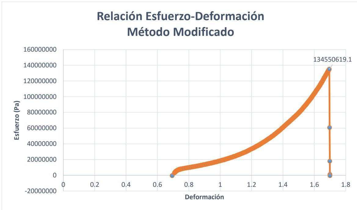
**Figura 15. Esfuerzo normal verdadero en función de la deformación relativa para el método modificado**
