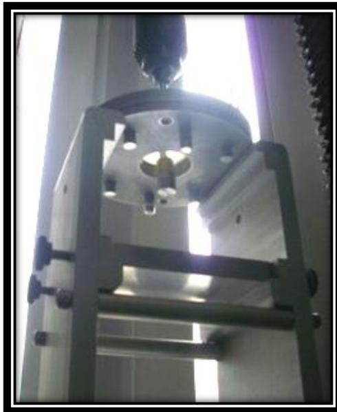
**Figura 7. Equipo Sintech durante la prueba de resistencia a la penetración.**
