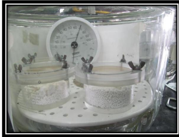
**Figura 8. Realización de la prueba de permeabilidad al vapor de agua.**
