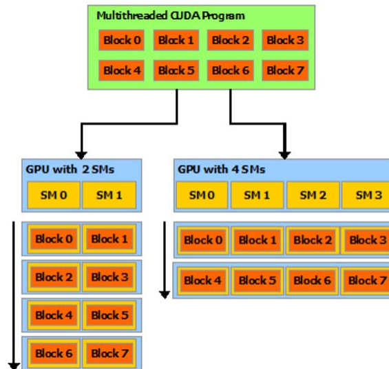
FIGURA 2.7: Los bloques de hilos son asignados a diferentes SM. [1]
