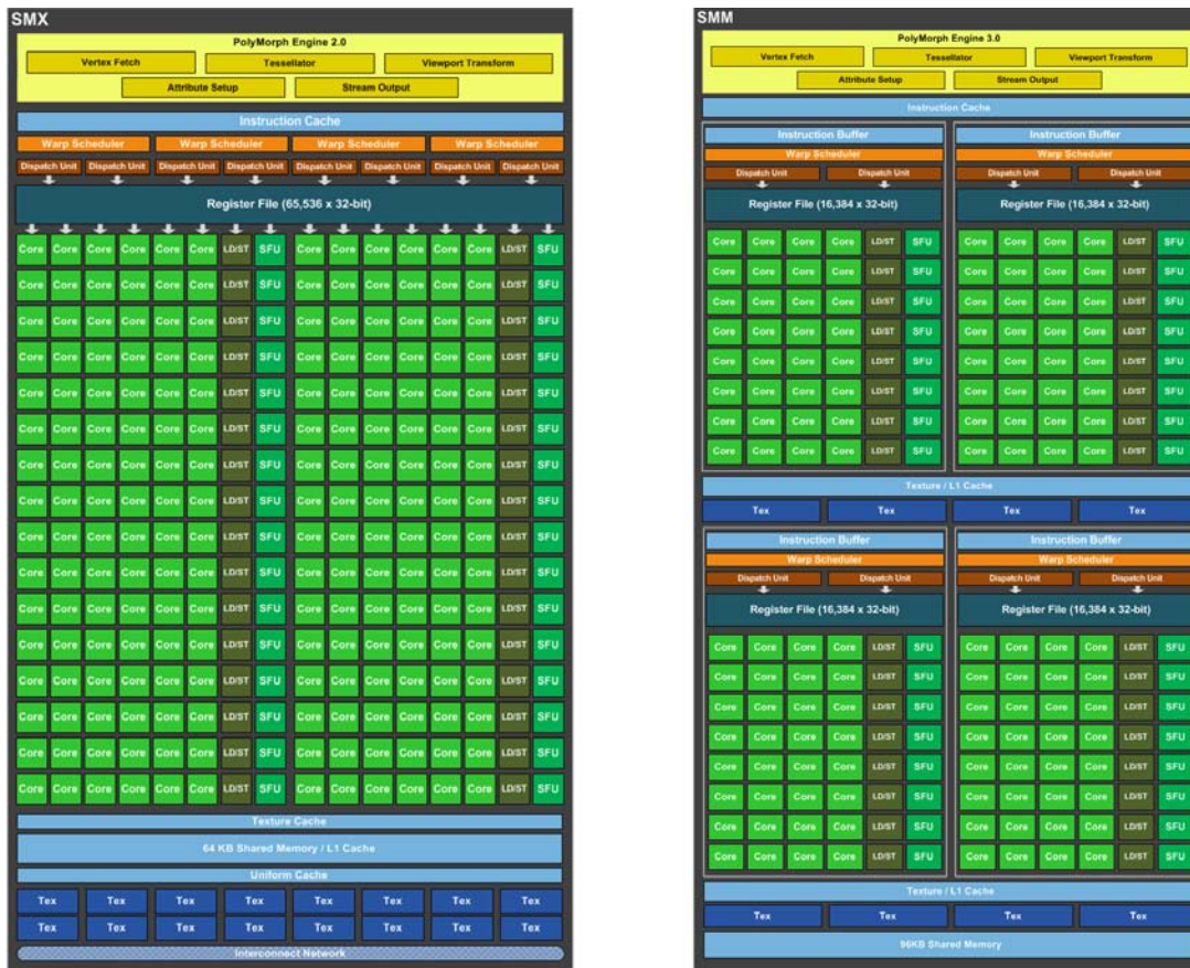
FIGURA 2.5: Comparación del SM en las arquitecturas Kepler (izquierda) y Maxwell (derecha). [6, 8]
