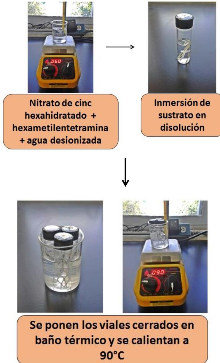
Figura III-2. Esquema del crecimiento de alambres submicrométricos.
