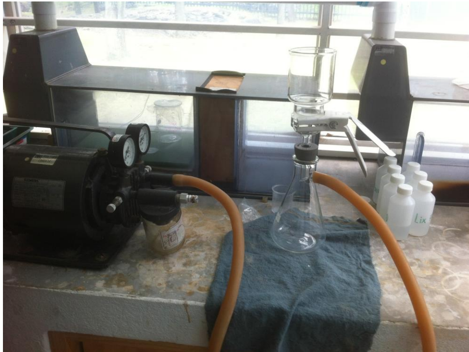
Figura 5.8. Matraz kitasato conectado a una bomba de vacío para filtrar solución de acetilacetato.
