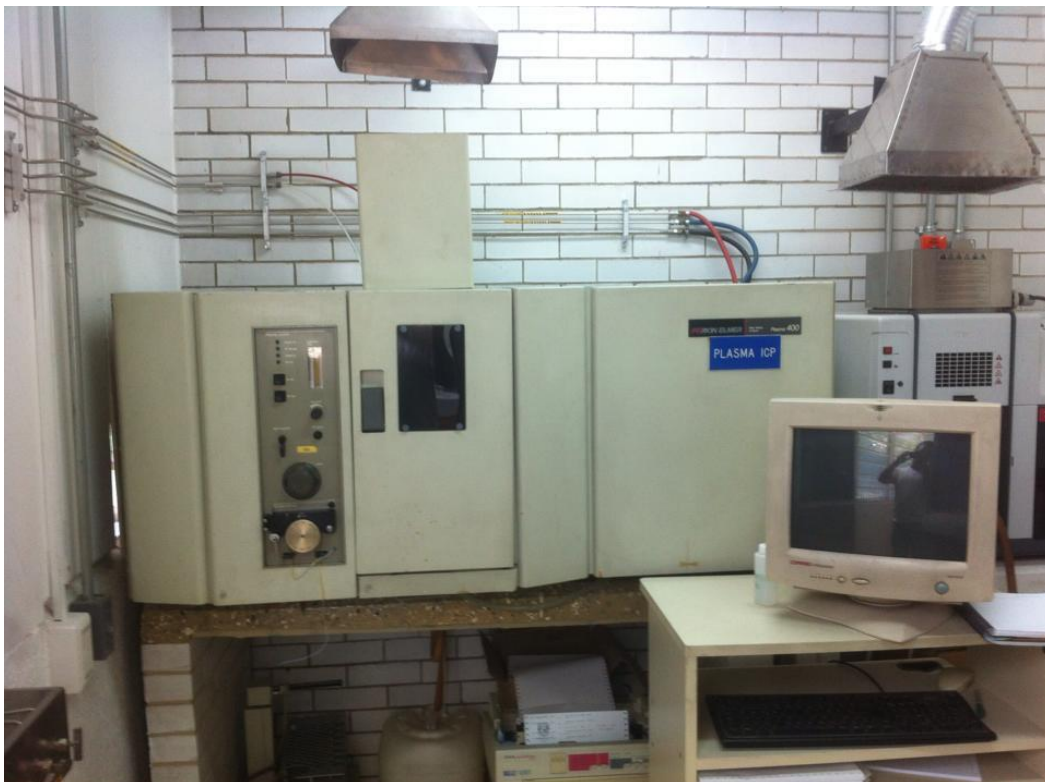
Figura 5.4. Equipo de ICP utilizado en la cuantificación elemental de las fracciones del jal. La cuantificación se elaboró en el Instituto de Geofísica, UNAM.
