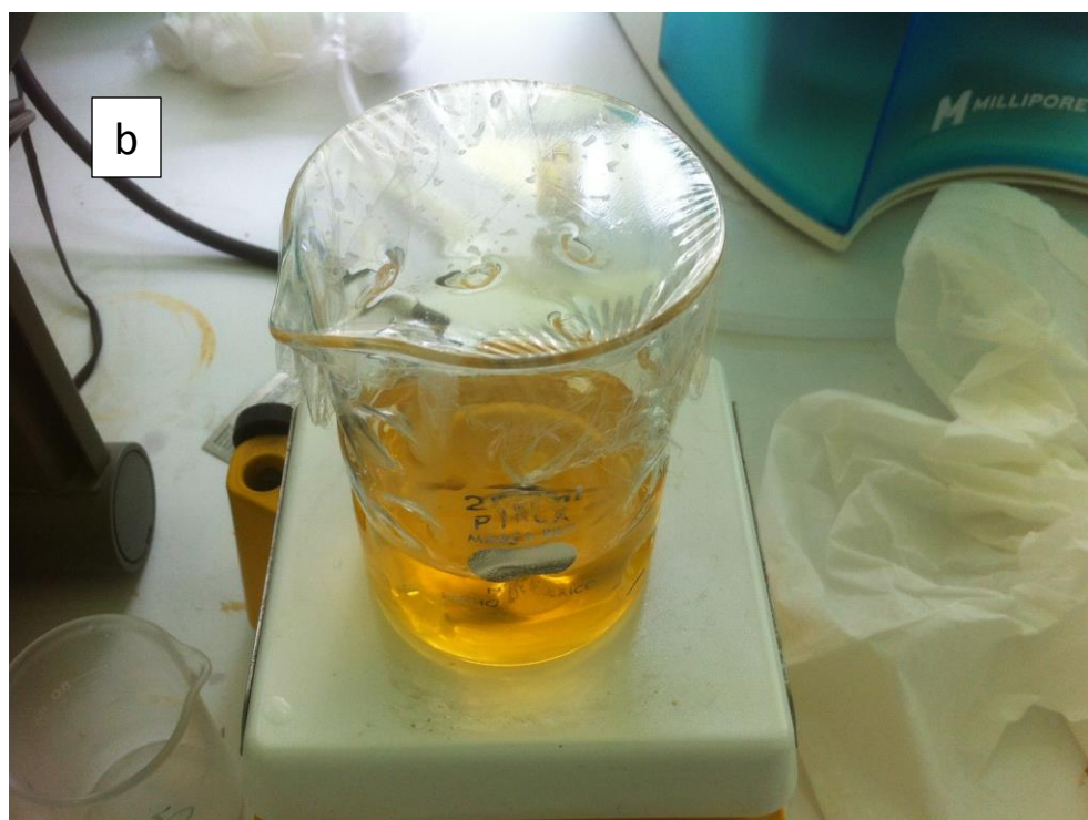
Figura 5.7. a) Ajuste de pH con agitación continua previa a la formación del acetilacetionato en celda promotora. b) Formación y precipitación del complejo de ETR en celda promotora con agitación continua.
