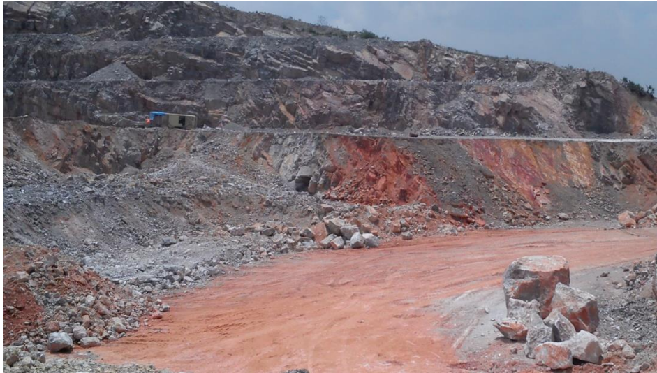
Ilustración 27. Roca de sobre tamaño resultante de la voladura
