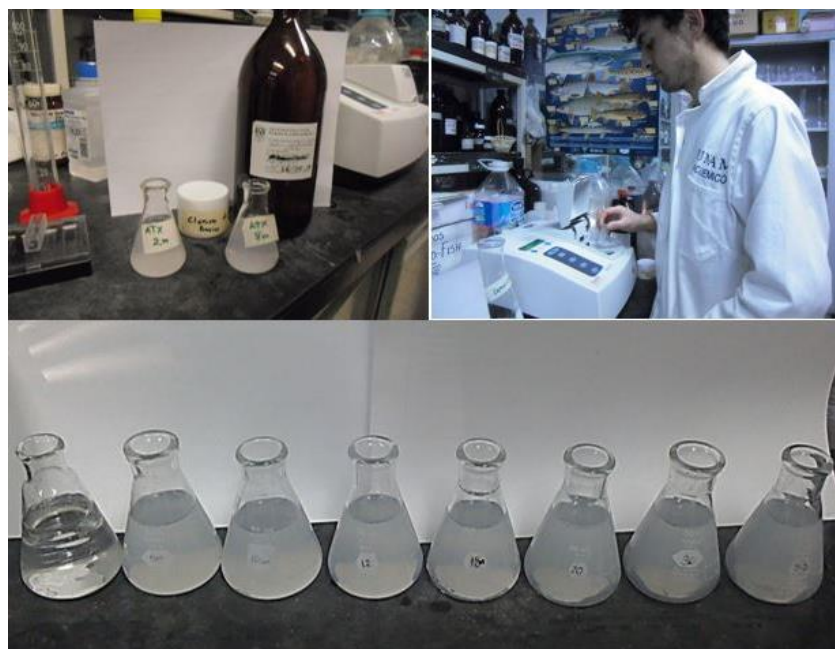
Fig. 9. Desarrollo de la técnica de sulfatos por el método turbidimétrico..
