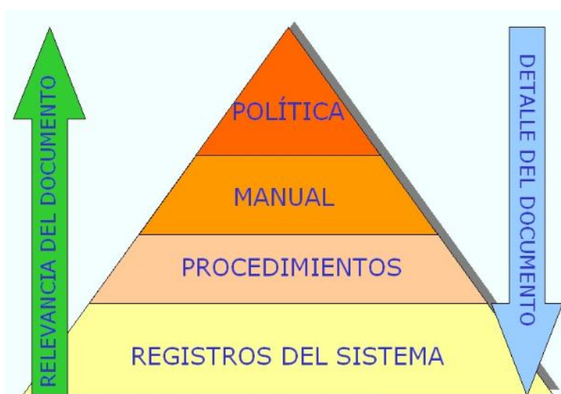
Esquema 18. Estructura de la documentación a partir del sistema de gestión de calidad.
