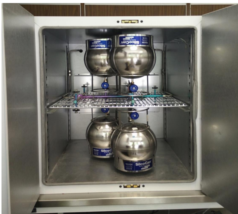
Figura 4.3 Sistema de limpieza de canisters modelo ENTECH 3100 A
