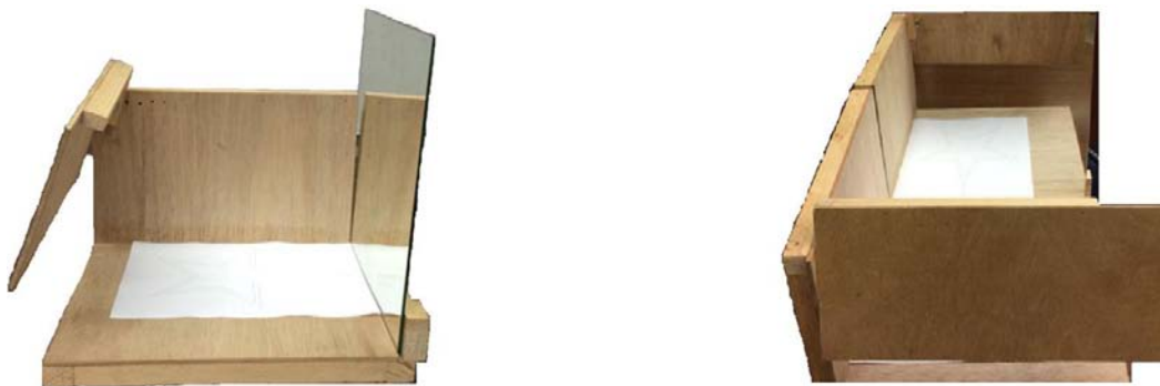
Figura 11. Dispositivo utilizado para el trazado de la estrella. El participante se situaba de frente al dispositivo, de tal forma que su vista fuera cubierta con el rectángulo de madera y sólo pudiera ver su mano y la estrella a través del espejo y no directamente.
