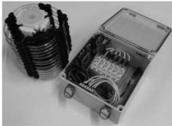
Fig. 1.3 Actuator robótico junto con su soporte electroneumático (válvulas de implementación)
