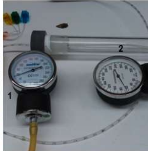
Fig. 4.21, Calibración del catéter. En la imagen de la derecha se observa que la magnitud de la presión del calibrador (2) y las microcámaras del catéter (1) no varía.
