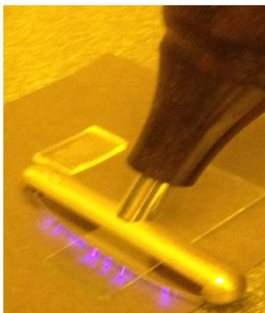
**Figura 20. Descarga de plasma en el portaobjetos para el pegado del microchip.**
