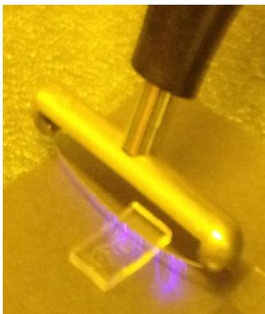
**Figura 19. Descarga de plasma en el microchip para su pegado.**
