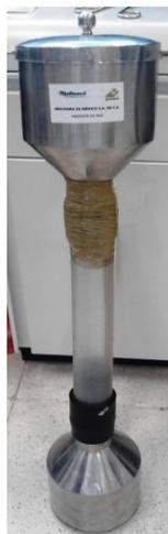
Figura 9. Medidor de volumen para pan
