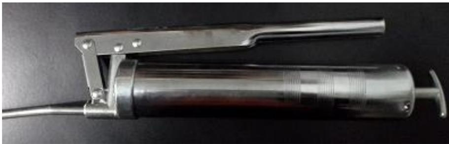
Fig. 41. Sistema de engrasado industrial (nuevo) que emplea un pistón a presión mecánica de acero inoxidable y una manga plástica interior, para dispensar la pasta dentro de la manguera.
