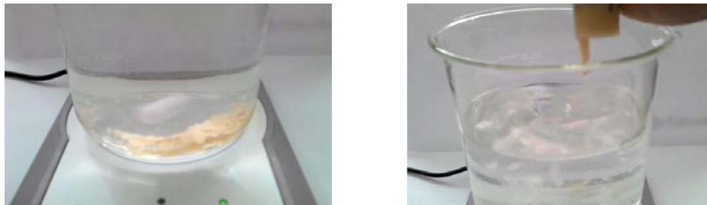
Fig. 20. Desarrollo de la prueba de tiempo de flotación de la pasta con agitación mecánica, usando un vaso de precipitados con 500 ml de HCl 0.1 M.
