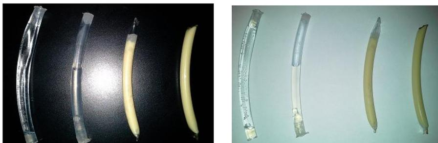
Fig. 18. Imágenes de las pruebas piloto del empaque primario y llenado del sistema de dosificación para la vía de administración oral; sellado mediante calor y silicón caliente, usando una solución gasificada y pasta de los lotes piloto para determinar la integridad a presión y volumen constante.
