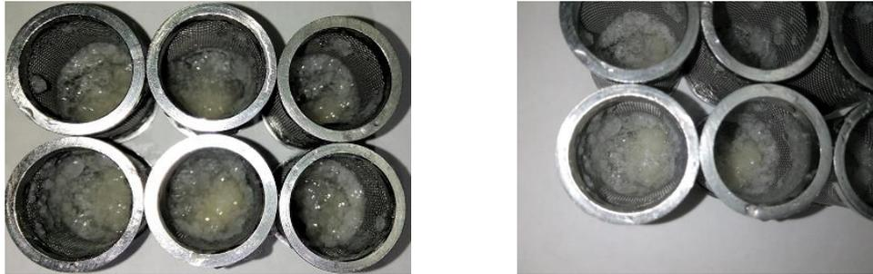
Fig. 23. Imágenes del aparato 1 (canastillas) después de la realización de la disolución de las pastas flotantes, en donde se evidencia la presencia de polímero.
