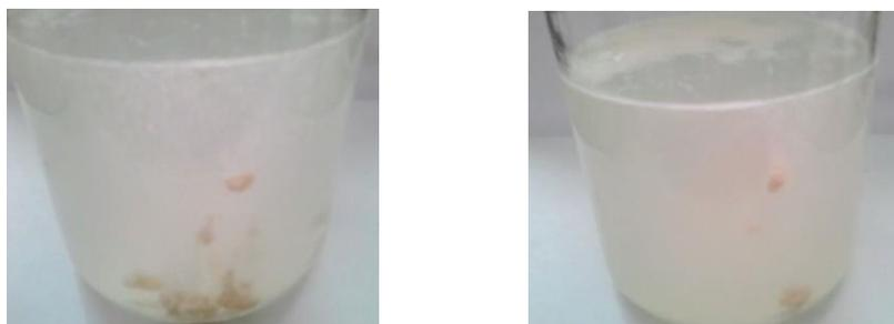
Fig. 19. Desarrollo de la prueba de tiempo de flotación de la pasta sin agitación, usando un vaso de precipitados con 500 ml de HCl 0.1 M.
