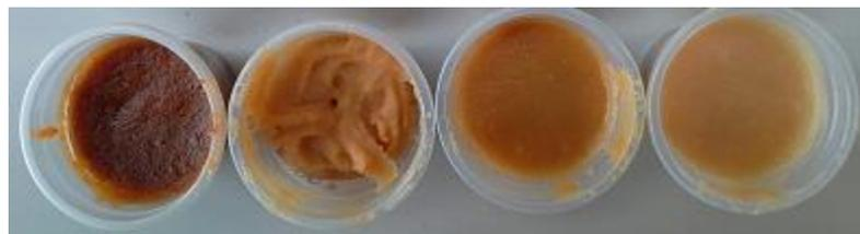
Fig. 17. Lotes piloto 004F, 007F, 010F y 013F, de 60 g de pasta para evaluar la estabilidad de la pasta después de la fabricación con propilenglicol como humectante.
