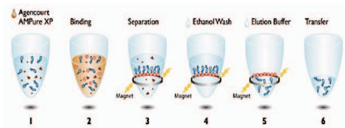
Figura 14. Uso de perlas de AMPURE y cama magnética: Al unirse las perlas de AMPure al DNA amplificado, el etanol y el uso de una cama magnética facilita la separación de los dímeros y primers libres
