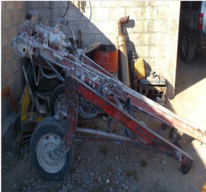
Figura 2.7 Perforadora utilizada en la cantera.
