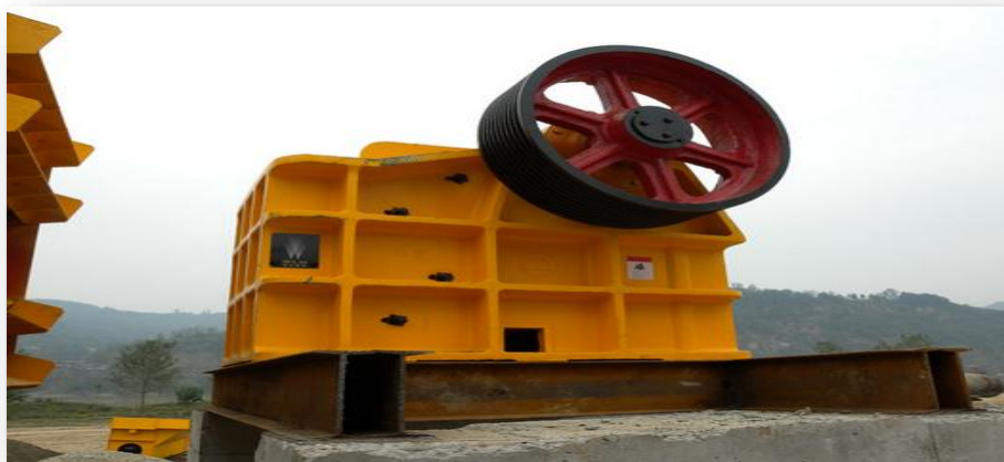
Figura 5.3 Trituradora de mandíbula PEX-150 x 250.
