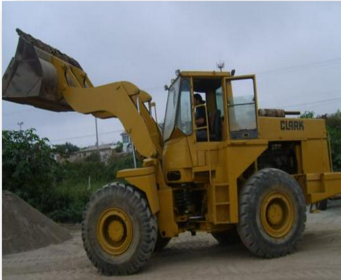
Figura 2.8 Cargador frontal utilizado para el rezagado en la cantera.
