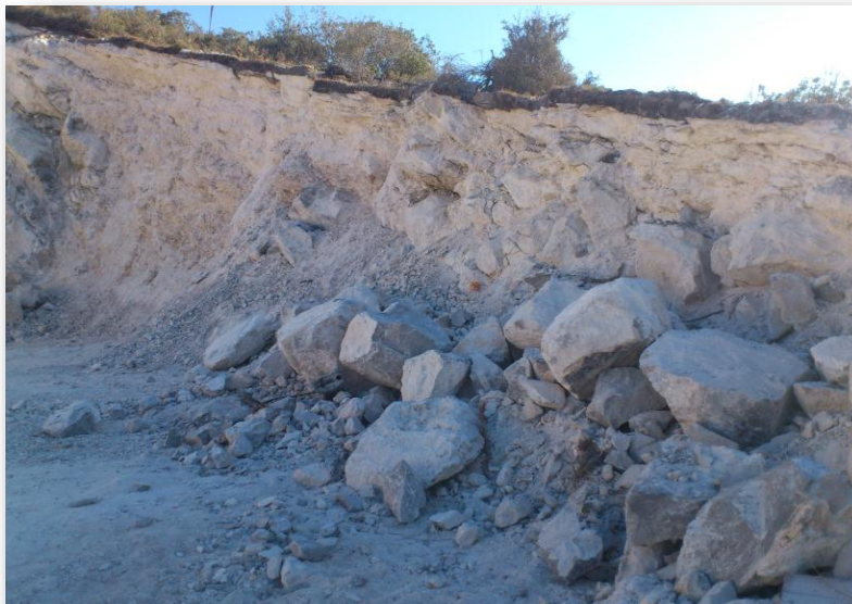
Figura 4.14 Acumulación de roca con sobre tamaño en la cantera Loma Blanca.
