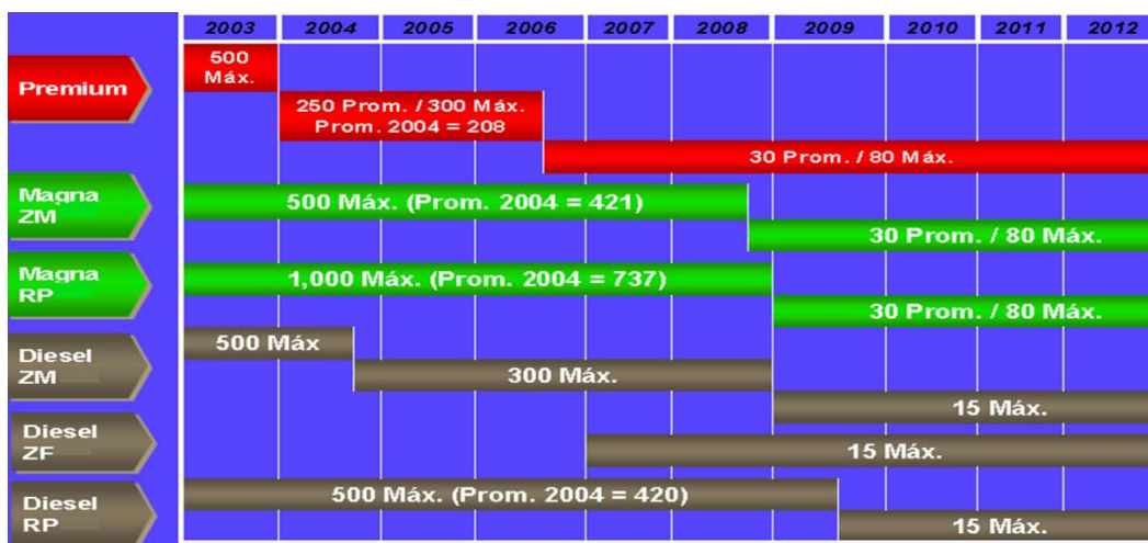
Figura 1.1. Cantidad de azufre permitida (ppm) en combustibles fósiles según la NOM-086-SEMARNAT-SENER-SCFI-2005 (ZM=Zona metropolitana, ZF=Zona fronteriza, RP= Resto del país) [9].
