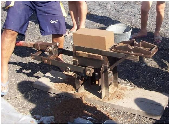
Fig 1/ BTC Bloques de tierra compactada.
