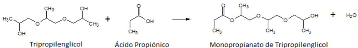
Figura 3.10 Reacción de producción de monopropianato de tripropilenglicol.
