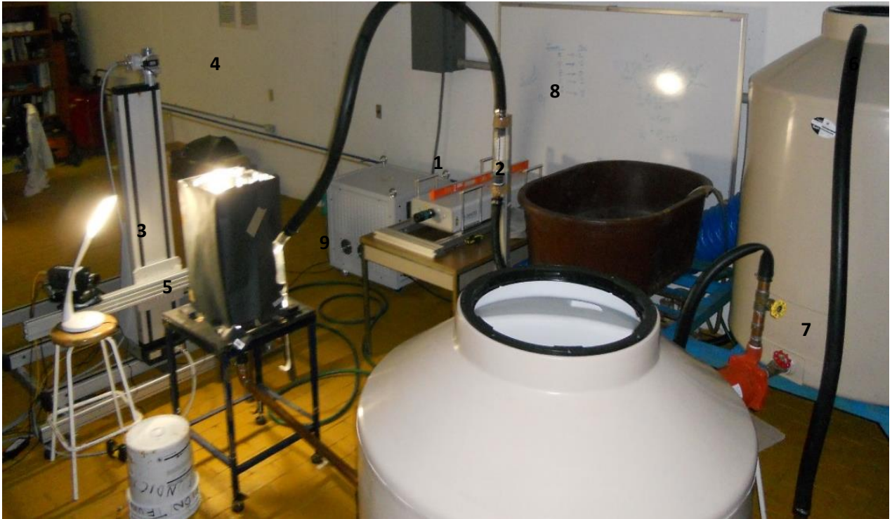
Figura 11a. Fotografía del arreglo experimental. 1)Controlador del láser, 2)Cabeza láser, 3)Cámaras de alta velocidad (2), 4)Soporte mecánico, 5)Lámparas de luz neón (2), 6) Tanque de agua (2), 7)Bomba de \frac{3}{4} de caballo de fuerza (2), 8)Rotámetro, 9)Modelo físico.
