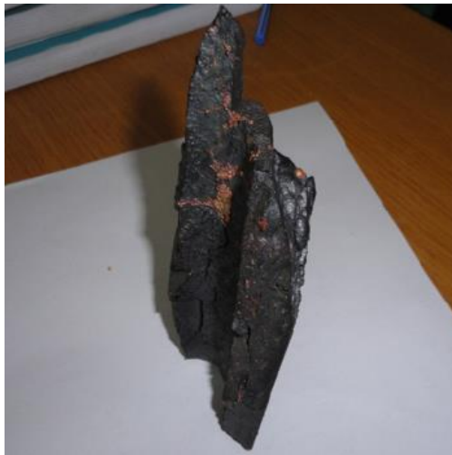
Figura 1.11 Mata de cobre atrapada en la escoria al enfriarse (Chikashi, 2011)
