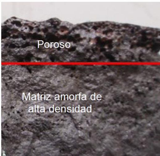
Figura 1.10 Estructura de los agregados de escoria al enfriarse (Modificado de Rozendaal y Horn, 2013).
