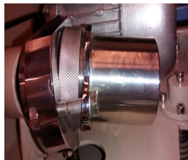
Figura 3.5. Carcasa de acero inoxidable y tapa roscada para molienda.
