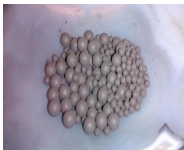
Figura 3.6. Esferas metálicas utilizadas en el molino de bolas para disminución de tamaño de partícula.
