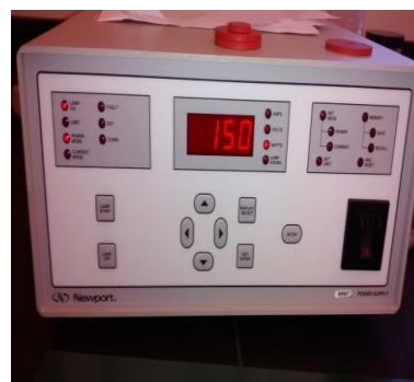
Figura 3.11. Fuente de poder de la lámpara de Xenón acoplada al simulador solar.
