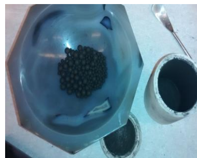
Figura 3.7. Esferas metálicas y recipiente de teflón después de molienda.
