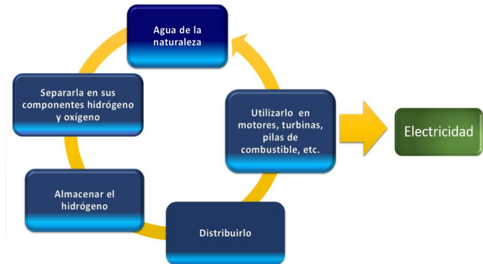
Figura 2.1. Ciclo de producción de hidrógeno mediante fotocatalisis heterogenea para aprovechamiento como energía eléctrica.
