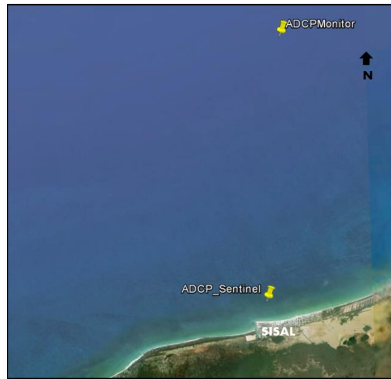
Figura 11. Localización de los equipos de medición ADCP, con respecto a la línea de costa de Sisal. Los instrumentos de medición se colocaron en el fondo del mar, cada uno sobre una estructura tipo trípode en la cual se monta el ADCP (Figura 12), en cada una de las patas tiene peso, con la finalidad de fijarlo al fondo y anclarlo lo suficiente para que las corrientes y el oleaje no lo muevan. La instalación se hizo a bordo de una embarcación del LIPC; con la ayuda de dos buzos y otras dos personas en la embarcación para cumplir con la maniobra de colocación del instrumento.
