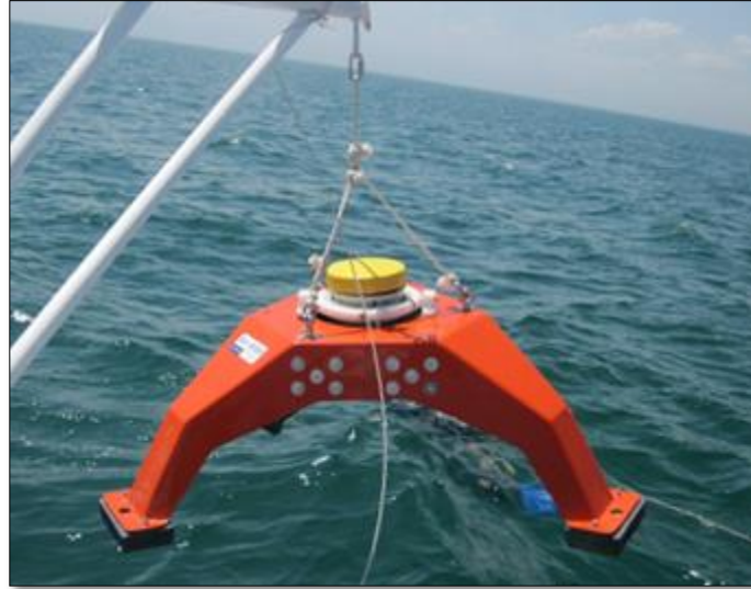
Figura 12. Ejemplo del instrumento de medición de oleaje ADCP.
