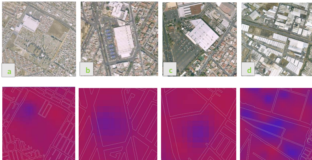
Imagen 23 Temperaturas bajas en cubiertas blancas: a) centro comercial las Torres de plaza Torrecillas, b) Walmart San Manuel, c) Plaza La Noria y d) zona industrial Puebla 2000, zona industrial Resurrección.
