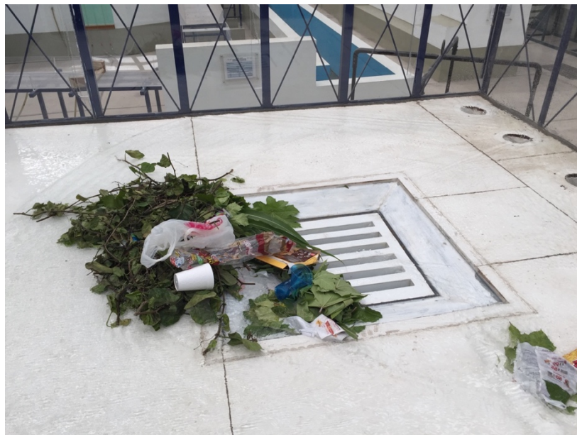
Figura 68 Arrastre de desechos sólidos durante el ensayo experimental
