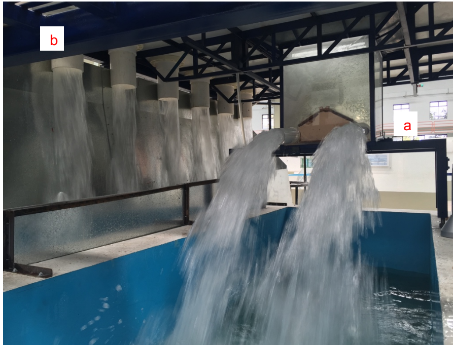
Figura 63 (a) Captación del flujo en la boca de tormenta. (b) Captación del flujo de derivación en las salidas aguas debajo de la boca de tormenta.
