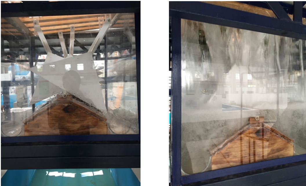
Figura 75 Boca de tormenta autolimpiable en funcionamiento.
