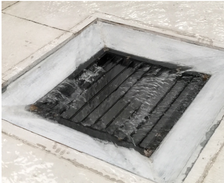
Figura 71 Flujo ingresando en la Rejilla de Barras a 45°
