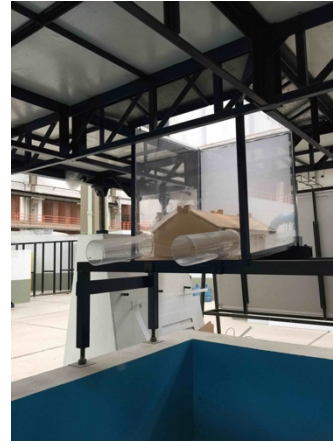
Figura 40 Cajón de descarga
