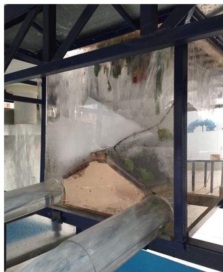
Figura 77 Problemática presentada en la boca de tormenta autolimpiable: saturación del cajón contenedor
