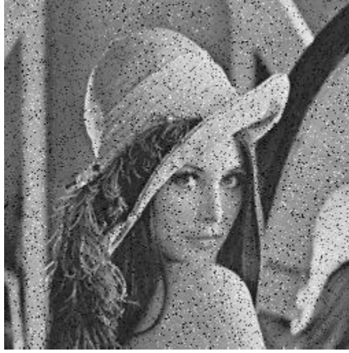
Figura 50 Imagen con ruido aditivo, sin control de errores, PSNR = 20.09 dB
