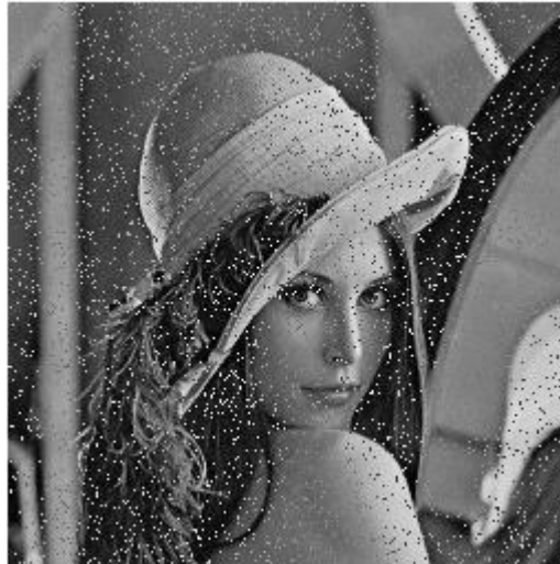
Figura 20 Imagen con ruido aditivo, sin control de errores, PSNR = 19.42 dB
