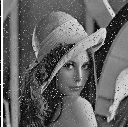
Figura 24 Imagen con ruido aditivo, sin control de errores, PSNR = 20.54 dB
