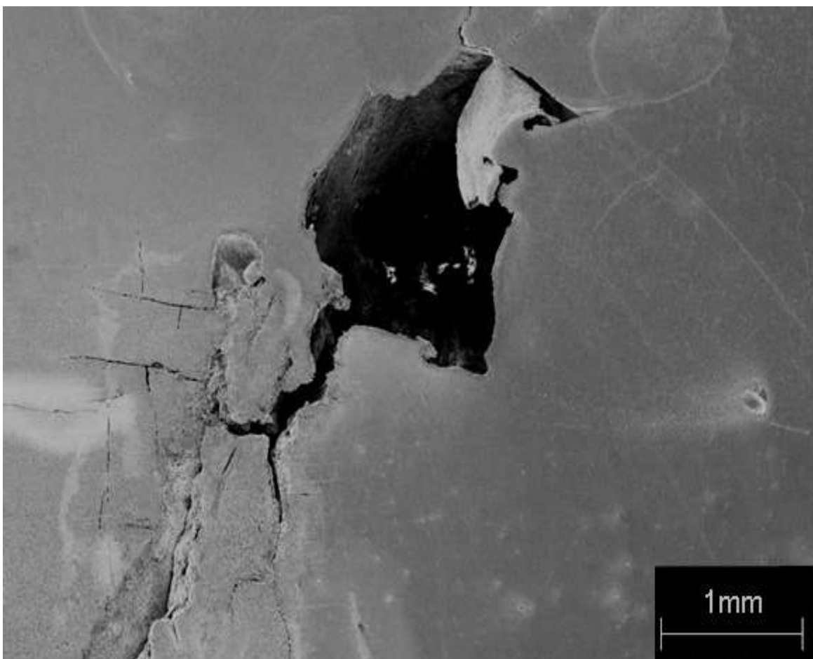
Figura 19. Grieta que presentó el reactor DC-101.
