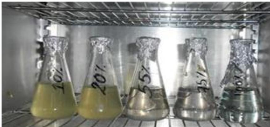
**Figura 15.** Muestras que conformaron los puntos de la curva de calibración bacteriana. De izquierda a derecha la densidad del consorcio es descendente
