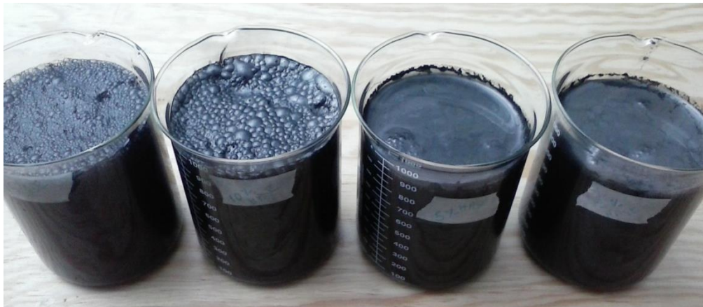
Figura 2.4. Soluciones de grafito con 14 días de exposición al ultrasonido y una concentración 15, 10, 5 y 2 % de HASE, de izquierda a derecha.
