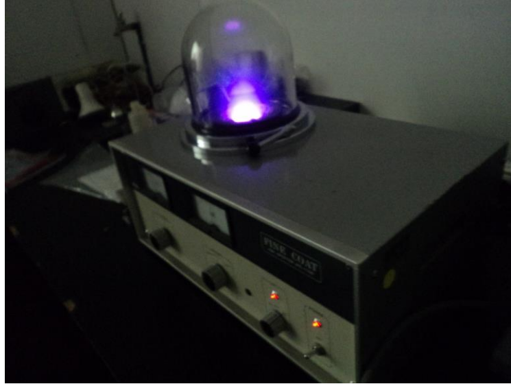
Figura 3.9. Evaporador al vacío JFC-1100 JEOL
