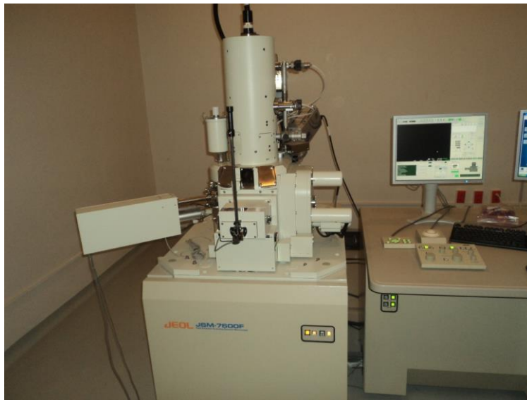
Figura 3.8. Microscopio electrónico de barrido de emisión de campo JSM-7600F
