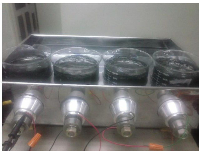
Figura 2.2. Baño ultrasónico, a un costado se observan los piezoeléctricos y en el interior de la bandeja las diferentes soluciones de grafito-HASE.
