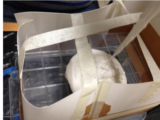
Figura 65: Vaciado de la mezcla en el molde
