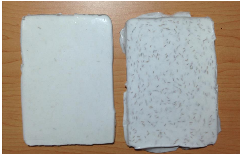
Figura 84: Retícula de caucho de silicón con fibra de henequén y de coco
