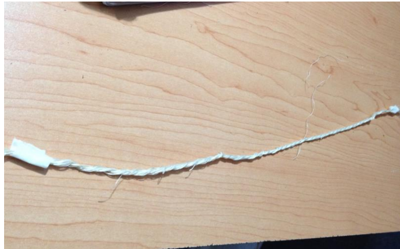
Figura 72: Configuración de la probeta de fibra de henequén (doble)
