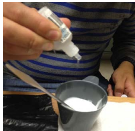
Figura 63: Vaciado del caucho de silicón y agregado del catalizador
