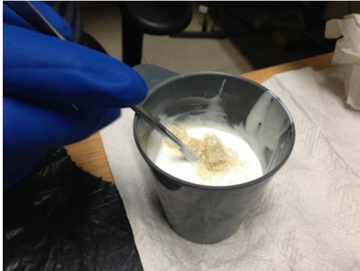
Figura 64: Vaciado de fibras en la mezcla
