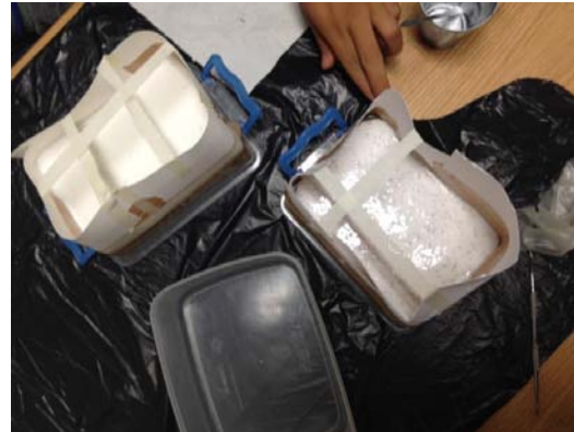
Figura 67: Conformación del caucho de silicón con la fibra de coco y de henequén
