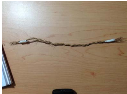
Figura 74: Configuración de la probeta de fibra de coco (doble)
