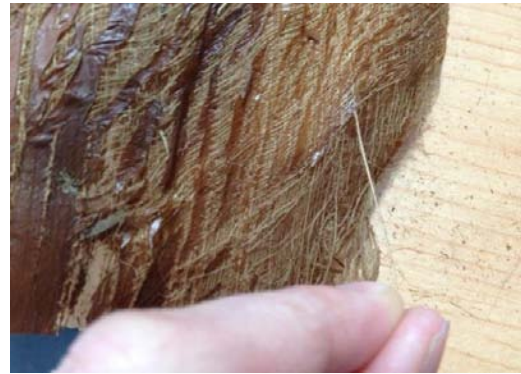
Figura 69: Desfibración de la hoja para extraer las fibras en mejores condiciones
