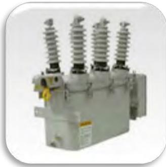
El restaurador es un dispositivo electromecánico que sirve para reconectar a los alimentadores primarios de distribución, por lo que son auto controlados para interrumpir y cerrar automáticamente circuitos con una secuencia de cierre y apertura, esta secuencia de operación podrá llevarse a cabo dependiendo el ajuste hasta tres veces seguidas, terminando con una operación definitiva de cierre o apertura.
