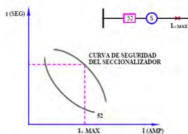
Figura 4.41 Criterio de coordinación relevador-seccionizador
