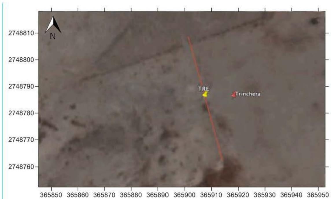
**Figura 5.4.-** Zona de estudio, trinchera. Línea roja: Tomografía de Resistividad Eléctrica (TRE). Punto rojo: Centro de la trinchera (*Google Earth, 2015*).
