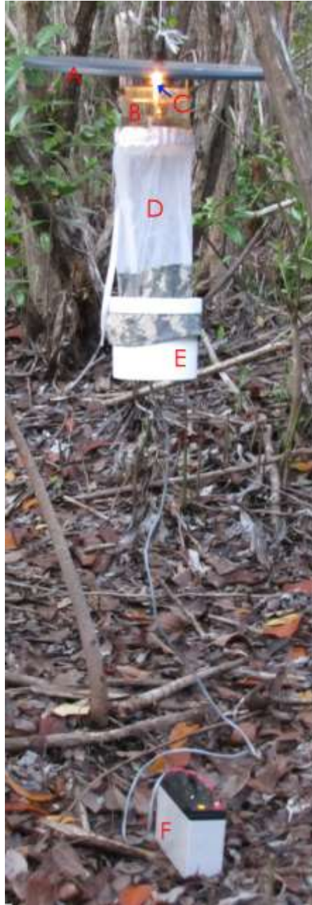
Figura 7. Trampa de luz tipo CDC, utilizadas para la captura de los flebotomíneos. Foto tomada por: Isabel Cristina Cañeda-Guzmán.
