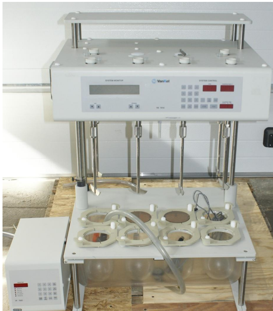
Figura 3. Disolutor, aparato 2 USP.
