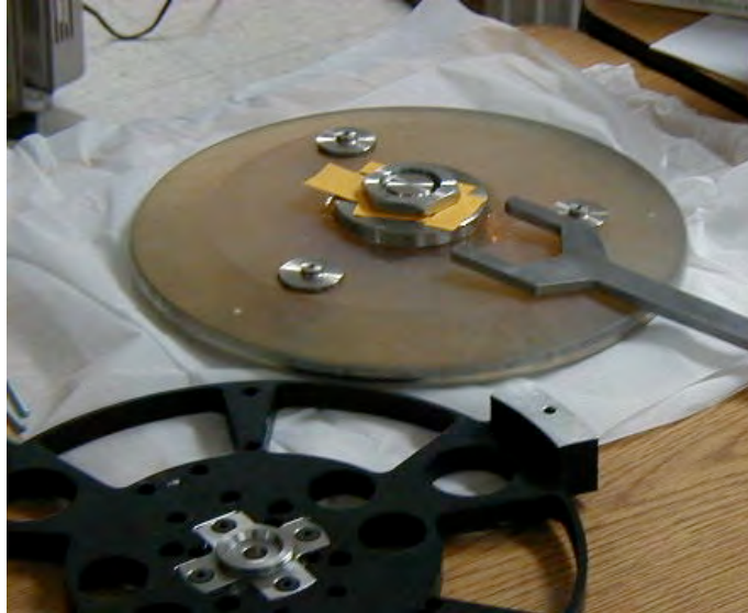
Figura 4-2. Manera actual de sujeción empleado en los espejos secundarios del OAN/SPM.
