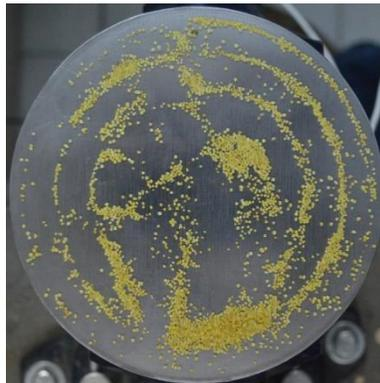
Fig 5.2. Se muestra una fotografía tomada a los anillos nodales que se forman a la frecuencia de 7.56 kHz.
