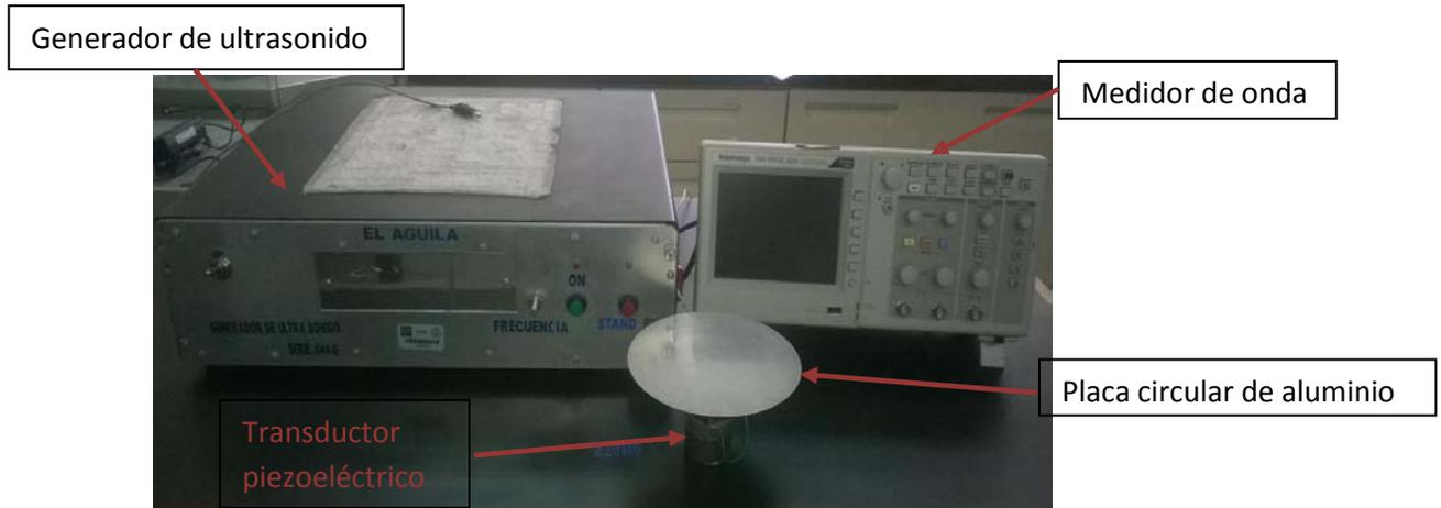
Fig. 5.1. Se muestra el montaje del equipo que se utilizó para realizar los experimentos.
