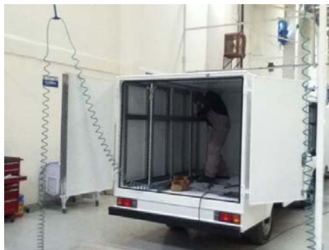
Figura 27. Instalación de estantería.
