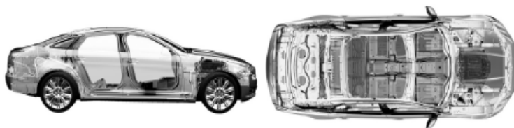
Figura 7. Chasis monocasco de aluminio. Jaguar XJ.
