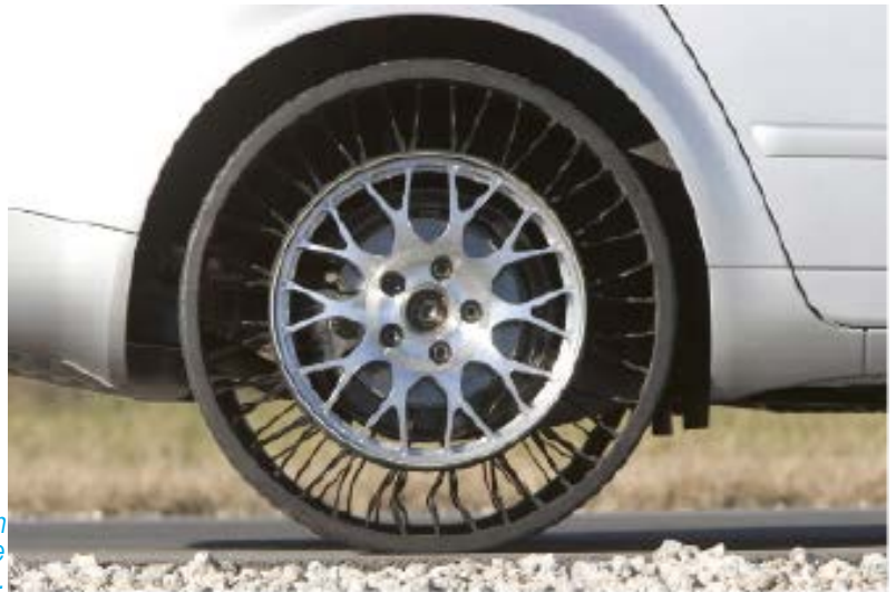
Figura 26. Neumáticos Michelin cuentan con rayos flexibles que se adaptan a la superficie..
